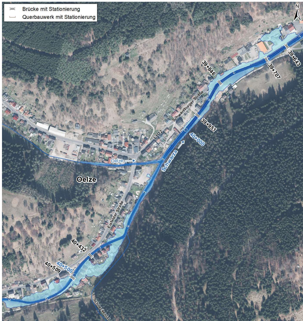
Abbildung 11.69: Katzhütte/ Oelze, Istzustand - Überflutungen bei HQ 100 , M 1:5.000
