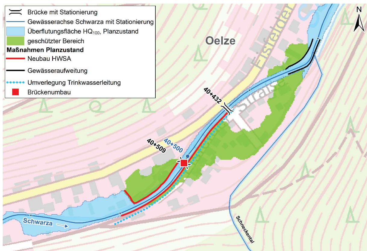
Abbildung 11.75: Katzhütte/ Oelze/ Schneckental, Planzustand – Maßnahmenübersicht und bei HQ 100 geschützte Bereiche, M 1:2.500
